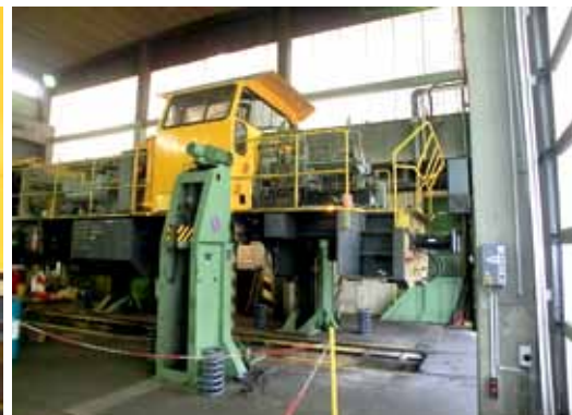
Foto links: die Lok 2 in den 90er Jahren vor der Einfahrt in den CHEMPARK Dormagen mit Lokrangierführer Rudi Kruchen; Foto Mitte: die halbfertige Lok nach Einbau des Motors; Foto rechts: die Lok 2 auf den Hebeböcken in Erwartung der Drehgestellrahmen
